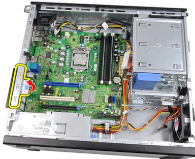
9. Entfernen Sie die Schrauben, mit denen die Systemplatine am Gehäuse befestigt ist.
