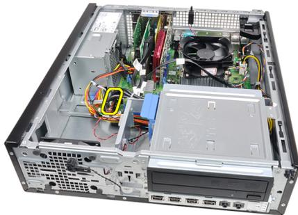
5. Entfernen Sie die Schraube, mit der die Eingabe/Ausgabe-Leiste am Gehäuse befestigt ist.
