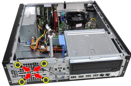
7. Heben Sie den Systemlüfter aus dem Computer und entfernen Sie ihn.
