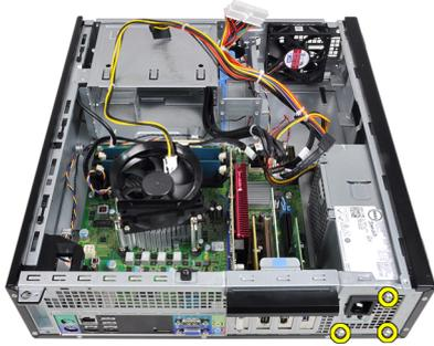
9. Drücken Sie auf die blaue Freigabelasche neben dem Netzteil und schieben Sie das Netzteil in Richtung der Computervorderseite.
