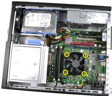
5. Heben Sie die Kühlkörperbaugruppe an und entfernen Sie sie vom Computer. Legen Sie die Baugruppe mit nach unten gerichtetem Lüfter und nach oben weisender Wärmeleitpaste hin.
