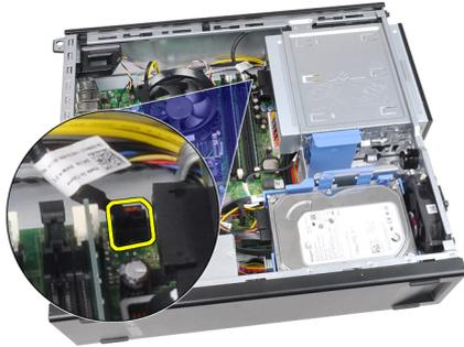
5. Hebeln Sie das Betriebssystemskabel los.
