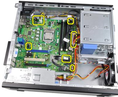
8. Heben Sie die Verriegelung der Erweiterungskarte an und entfernen Sie sie, um Zugriff auf die Befestigungsschrauben der Systemplatine zu erhalten.
