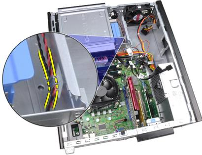
5. Drücken Sie die Sicherungslasche des Lautsprechers herunter und schieben Sie den Lautsprecher nach oben, um ihn zu entfernen.
