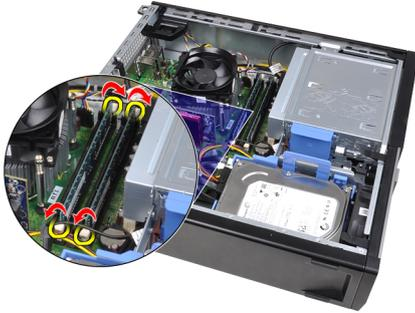
4. Heben Sie die Speichermodule aus den Anschlüssen auf der Systemplatine.
