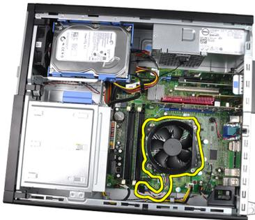
6. Drücken Sie den Entriegelungshebel herunter und bewegen Sie ihn dann nach außen, um ihn von dem Rückhaltehaken zu lösen, der ihn sichert.
