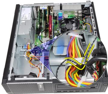
5. Hebeln Sie den Temperatursensor vom Netzteil weg und entfernen Sie ihn vom Gehäuse.
