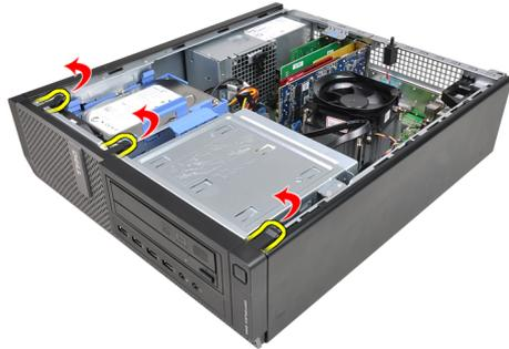
4. Drehen Sie die Verkleidung seitlich vom Computer weg, um die Haken auf der gegenüberliegenden Seite der Verkleidung aus dem Gehäuse zu entfernen.
