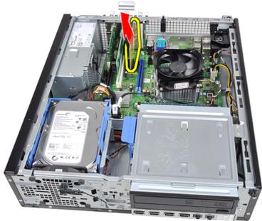
6. Heben Sie die PCI-Erweiterungskarte (falls vorhanden) hoch und aus Ihrem Anschluss und entfernen Sie sie aus dem Computer.
