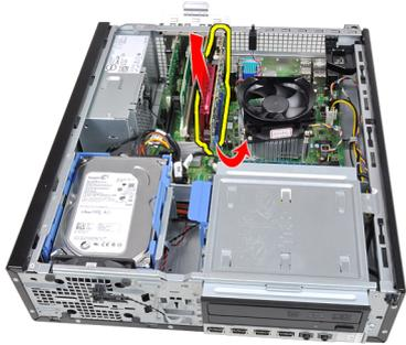
5. Heben Sie die PCIe x1-Erweiterungskarte (falls vorhanden) hoch und aus Ihrem Anschluss und entfernen Sie sie aus dem Computer.
