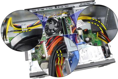
6. Lösen Sie das Kabel des Temperatursensors aus der Gehäuseklammer.
