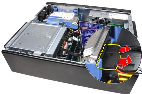
4. Drücken Sie die Festplattenlaufwerkhalterung in Richtung der Festplatte und heben Sie sie an.
