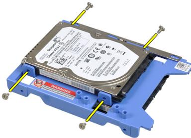
7. Biegen Sie die Festplattenlaufwerkhalterung und nehmen Sie die zwei 2,5 Zoll-Festplattenlaufwerke aus der Halterung.
