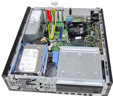
7. Heben Sie die PCIe x4-Erweiterungskarte (falls vorhanden) hoch und aus Ihrem Anschluss und entfernen Sie sie aus dem Computer.
