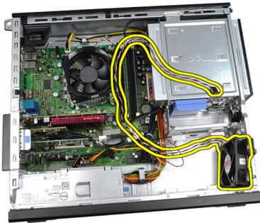
8. Hebeln Sie die vier Befestigungsschrauben hinauf und entfernen Sie sie vom Systemlüfter.
