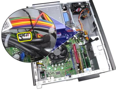
4. Lösen Sie das Lautsprecherkabel aus der Gehäuseklammer.
