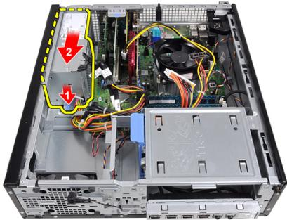
10. Heben Sie das Netzteil aus dem Computer heraus.
