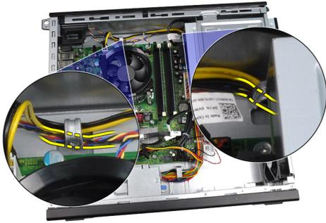
6. Schieben Sie die vier Gummiösen nach innen und durch die Schlitz auf der Computervorderseite.
