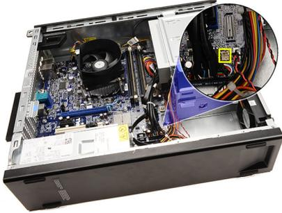
5. Lösen Sie das Kabel des Temperatursensors aus den Gehäuseklammern.
