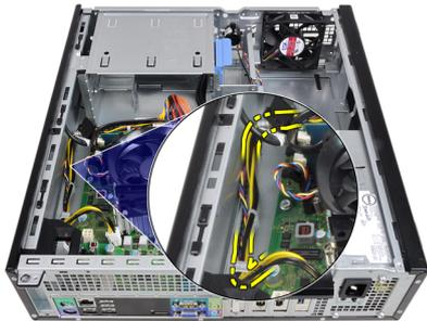
6. Trennen Sie das 24-polige Stromversorgungskabel von der Systemplatine.
