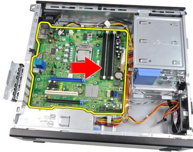
11. Entfernen Sie die Systemplatine aus dem Gehäuse.
