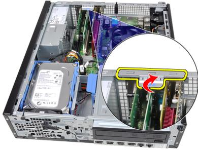
4. Drücken Sie den Entriegelungshebel von der PCIe x16-Karte weg, um die Sicherungslasche von der Einbuchtung in der Karte zu lösen. Dann ziehen Sie die Karte vorsichtig nach oben und aus ihrem Anschluss und entfernen sie aus dem Computer.
